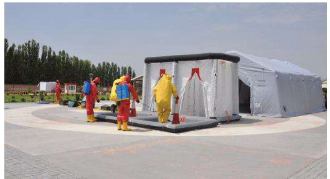
Sanitar təmizlənmənin keçirilməsi üçün müasir deqazasiya duş kabinəsi
